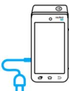
Se recomienda cargar el Pos Touch por **6 horas** con la finalidad de tener un correcto funcionamiento. El dispositivo trae consigo un cable y cargador, los cuales podrás enchufarlos a un tomacorriente de pared o con el cable en una computadora o laptop.
