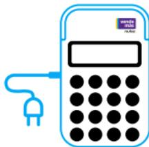
Se recomienda cargar el Poket por **6 horas** con la finalidad de tener un correcto funcionamiento. El dispositivo trae consigo con un cable e interruptor, los cuales podrás enchufarlos a un tomacorriente de pared o con el cable en una computadora o laptop.
