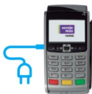
Se recomienda cargar el POS por **6 horas** con la finalidad de tener un correcto funcionamiento. El dispositivo trae consigo con un cable e interruptor, los cuales podrás enchufarlos a un tomacorriente de pared o con el cable en una computadora o laptop.
